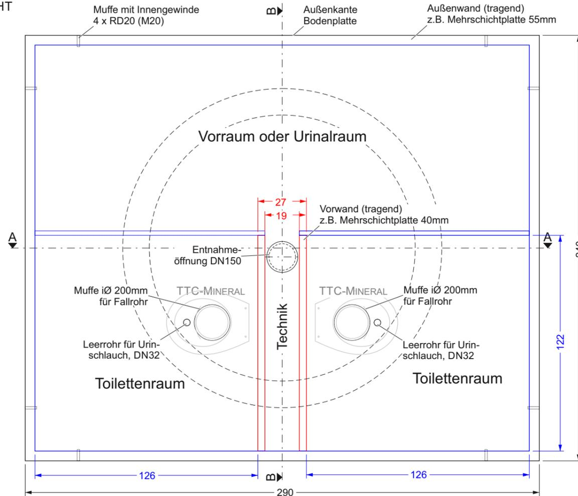
**Achtung:** Die in der Bodenplatte vorhandenen Muffen für die TTC-Fallrohr und die dazugehörigen Leerrohre für die Urinschläuche sind nicht veränderbar und legen die Standorte der beiden TTC-Mineral fest. Die Angaben in **ROT** sind einzuhalten.
